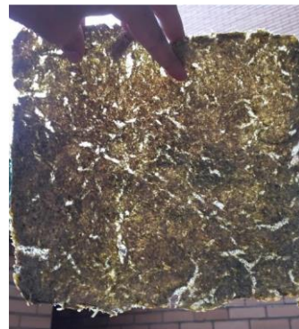
Figura 5. Biolámina de lechuga con agrietamientos y manchas
