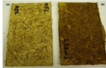
Figura 2. Ejemplo de tablero obtenido por moldeo por compresión a partir de paja de trigo. Recuperado de: https://sage.proxyuao.elogim.com/doi/full/10.1179/1743284713Y.0000000459
