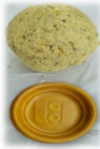
Figura 1. Biomasa o bioplástico moldeable de cáscara de naranja (parte superior). Plato hecho por termocompresión del mismo material (parte inferior).
